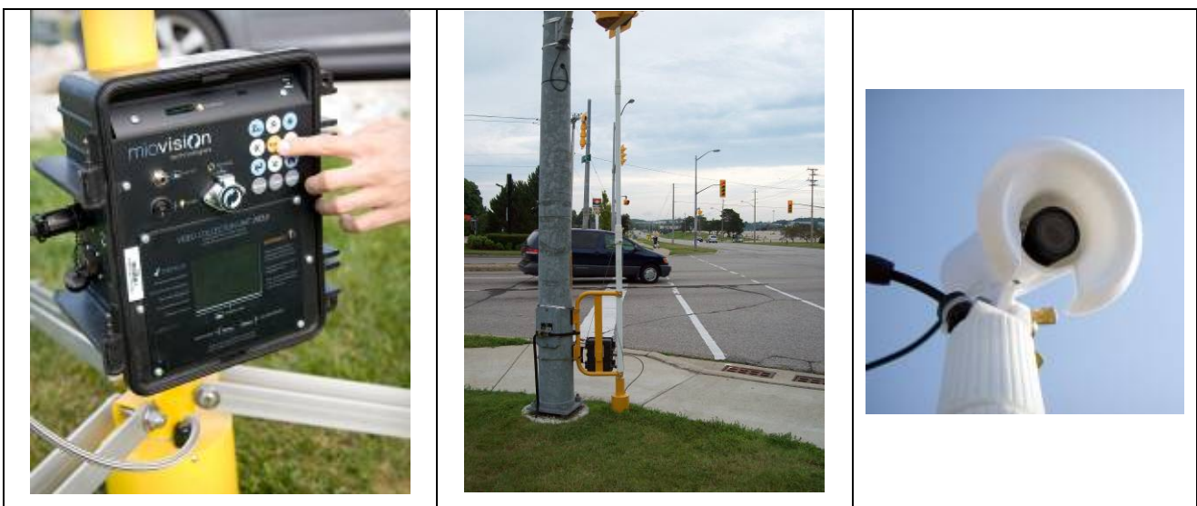
Figura 4: Unità Miovision e posa in opera della stessa
